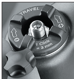
Fig. 2 Bouton du capuchon et valve Schrader du modèle TALAS
